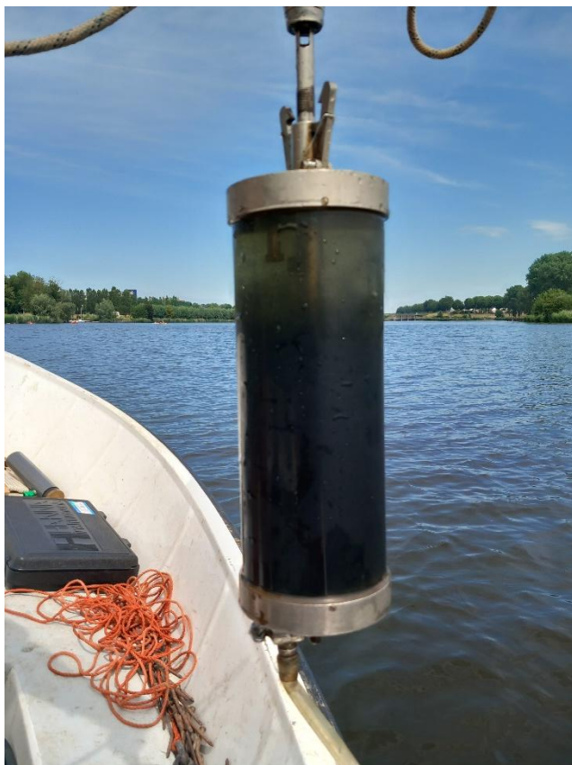
Figuur 4, Watermonster genomen met de waterhapper op 3 meter diep. Hierin is duidelijk de zwevende sliblaag te zien
